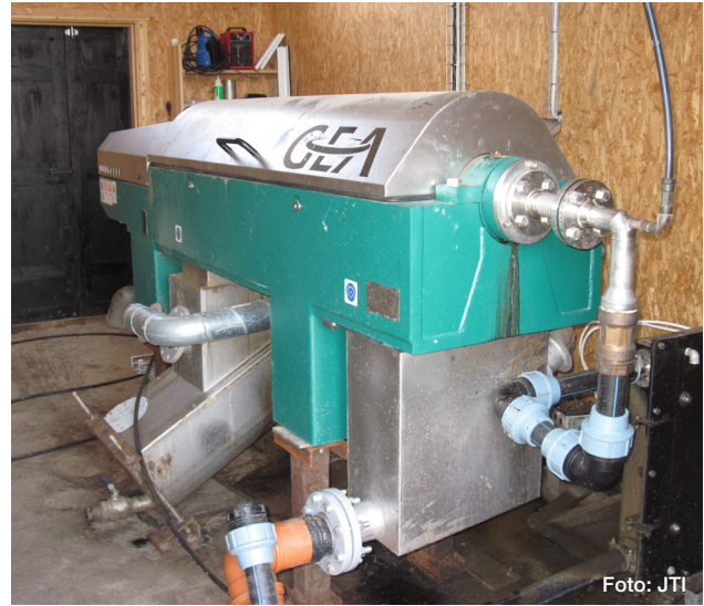
Figur 11. Med en separator delas fastgödseln upp i en fast och en flytande fas, där den fasta delen innehåller en stor del av fosfor och det organiska kvävet.
