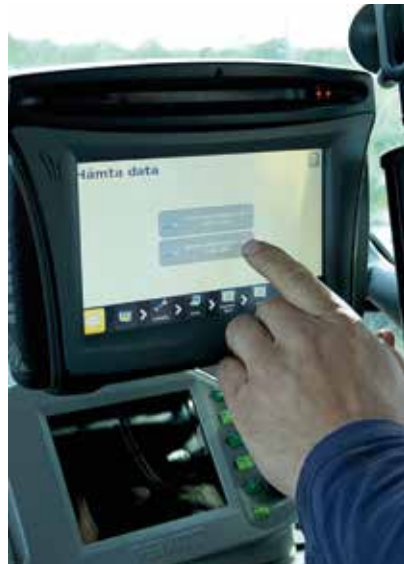
Styrfilerna läggs på ett USB-minne och laddas sedan in för att styra gödselspridaren.
