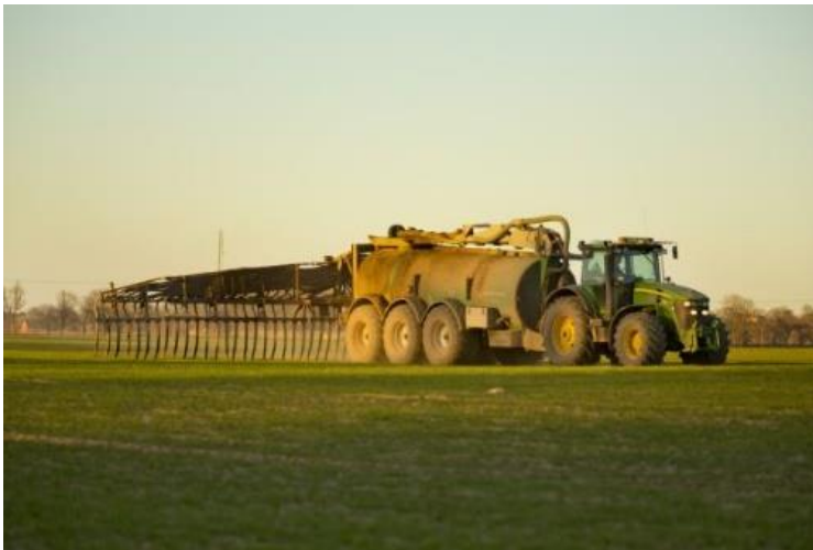
Figur 13. Spridning av flytande organiska gödselmedel med släpplangsutrustning. Gödseln placeras direkt på markytan, vilket minskar förlusterna jämfört med om spegelspridare används. (Foto: Mårten Svensson)
