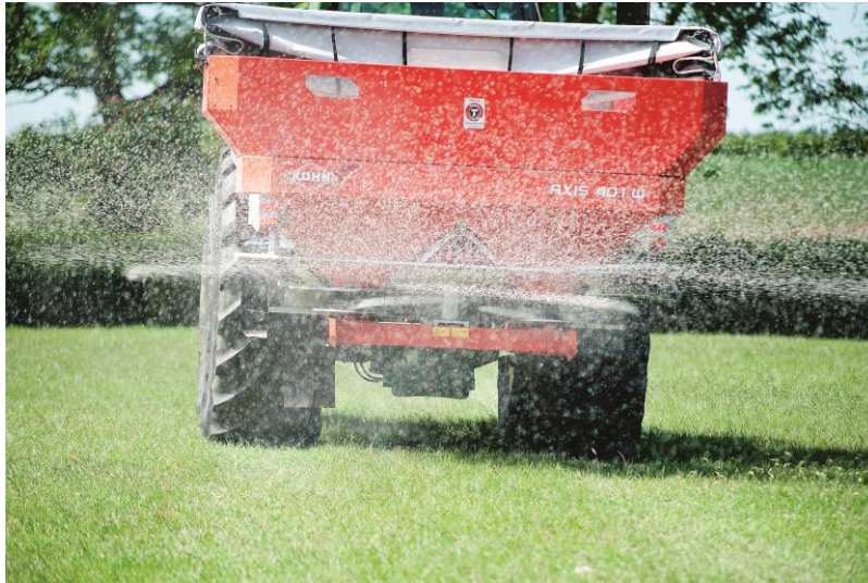
Figur 9. Med en centrifugalspridare sprids gödseln ovanpå markytan. Foto: Yara
