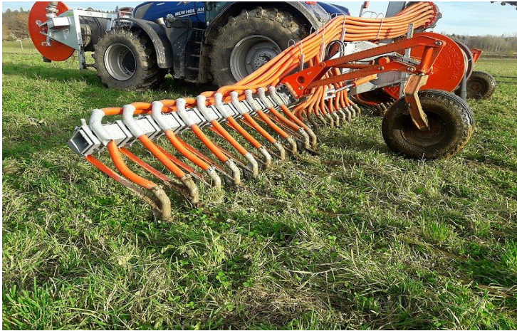
Figur 14. Det finns olika typer av spridare som direkt under spridning placerar gödseln under markytan. Detta är det mest effektiva sättet att använda flytande organiska gödselmedel. (Foto Emelie Andersson)
